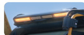
アームクレーンモード使用時 （アームクレーン仕様のみ）
